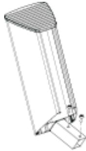
2. Schrauben Sie die beiden Schrauben, die bereits am Standfuß vormontiert sind heraus.
