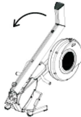
5. Entriegeln Sie den Klappmechanismus, indem Sie den Sperrhebel mit dem Fuß herunterdrücken. Klappen Sie nun die gesamte Gleitschiene vorsichtig herunter.
